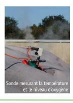
La montée en température (jusqu'à 60-70°C) permet de détruire les micro-organismes nuisibles et les semences de mauvaises herbes. La matière est transformée en matière
